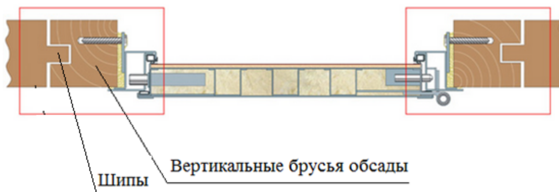
рис. 2 Установка обсады на шипы
